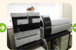
血液濾紙を直径3mmくらいに打ち抜き、染み こんだ血液の成分を抽出してタンデムマス 質量分析計にかけ、代謝物質を測定します。 この大きさの血液濾紙1個から分析時間2分 弱で20種以上の病気について検査できます。
